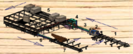
Схема работы линии Sarmax пропитки и выполнения отделочных работ
