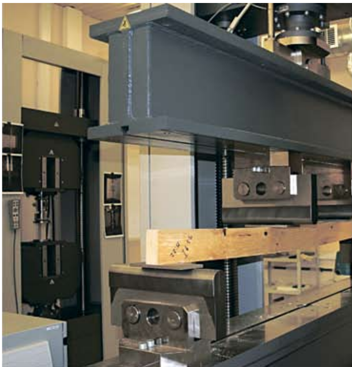
Рис.1. Испытание бруса Ultralam на изгиб
